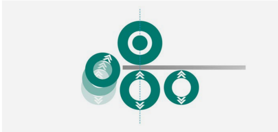
1. Blech einlegen und ausrichten, die Seitenwalze dient als Anschlag
