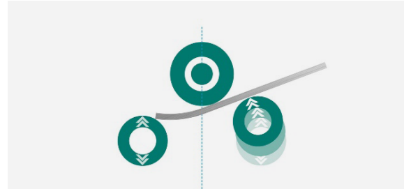
2. Anbiegung, das Blech wird zwischen den Seitenwalzen geklemmt
