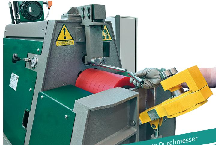
Sonder-Oberwalzen für kleinste Durchmesser
