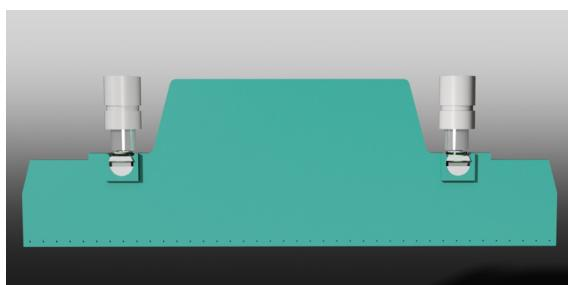
Der Pressbalken ist mit den Zylindern gekoppelt. Doch anstatt die Zylinder starr mit dem Pressbalken zu koppeln, wie es bei Abkantpressen üblich ist, sind die Zylinder bei der Industrie-Baureihe durch ein Kugelgelenk mit dem Pressbalken verbunden.
