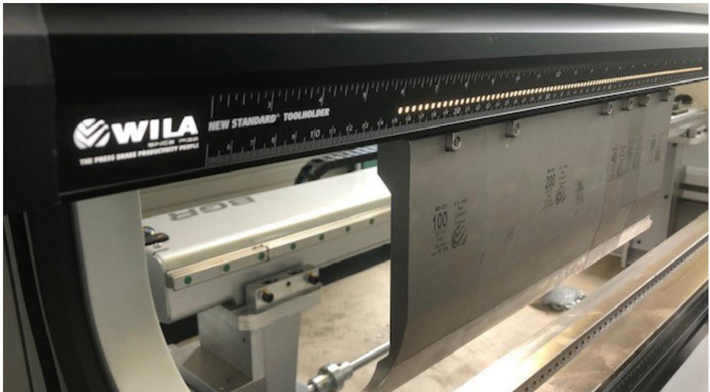
Ein LED-Lichtband auf der Oberwerkzeug-Klemmung zeigt die korrekte Position für den Werkzeugeinbau entsprechend dem Kantprogramm. Bei mehreren Kantstationen zeigt das Lichtband die jeweils im Programmschritt aktive Station an.
