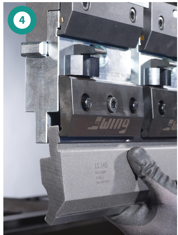
Oberwerkzeug vertikal herausnehmen
