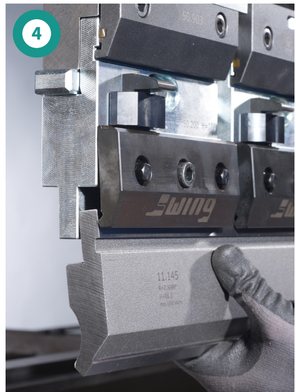
Oberwerkzeug vertikal herausnehmen
