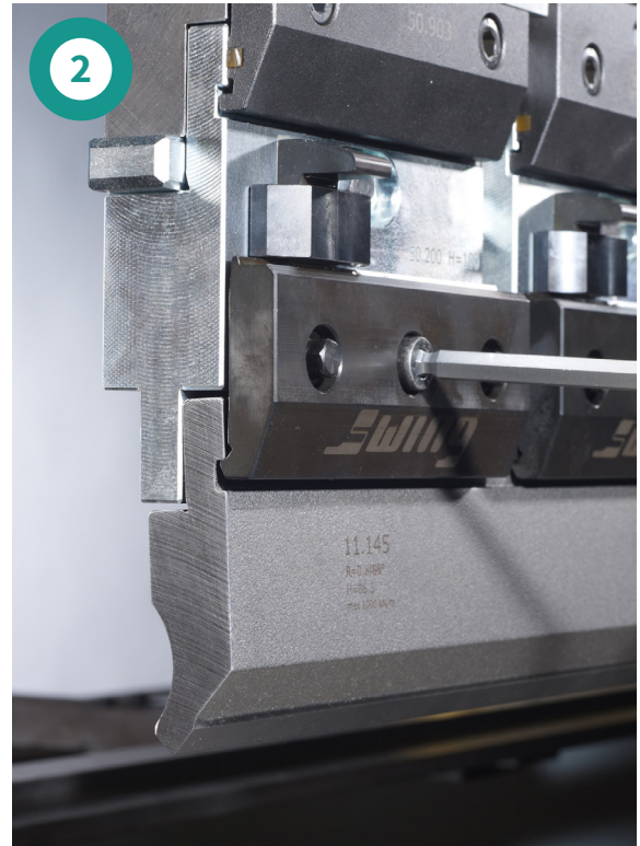
Schraube lösen, das Oberwerkzeug ist gegen Herunterfallen gesichert
